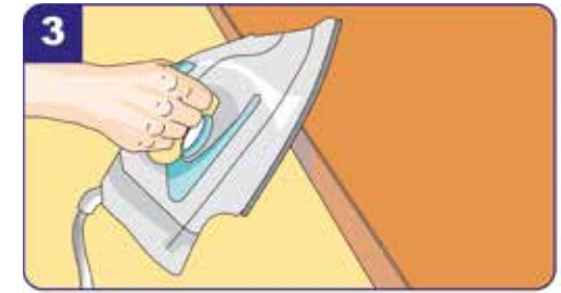
3 Der Umleimer wird mit einem Bügeleisen auf die offene Stirnseite aufgebügelt oder alternativ mit extra dafür vorgesehenem Kleber verklebt. Die Fronten der Arbeitsplatte mit individuell gewähltem Umleimer beschichten.
