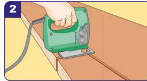
2 Neue Arbeitsplatte an den Verlauf der Wand anpassen und Wandvorsprünge sowie Ecken und Kanten mit der Stichsäge ausschneiden.
