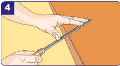
4 Die Überstände des Umleimers mit einer groben Feile abschleifen. Den Schliff mit feinem Schleifpapier vollenden.
