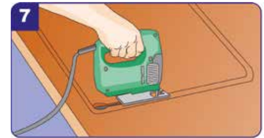
7 Um die Ausschnitte aussägen zu können, bohren Sie ein Loch in eine Ecke der Aufzeichnung. Sägen Sie nun mit der Stichsäge entlang Ihrer Kontur den Ausschnitt aus. Achtung: Bitte beachten, nach dem Ausschnitt die Platten nur noch mit 2 Personen bewegen, da eine erhöhte Bruchgefahr besteht!
