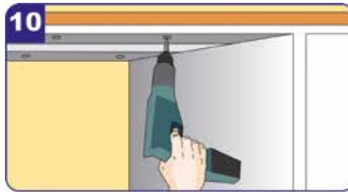
10 Die Arbeitsplatte wird von unten durch die Querverbindungen der Unterschränke fest verschraubt. Wichtig ist, dass die Unterschränke waagrecht ausgerichtet sind. Orientieren Sie sich dabei an den Stellfüßen. Bei Nichtbeachtung können sich Verschiebungen ergeben oder die Platte unter Spannung stehen.
