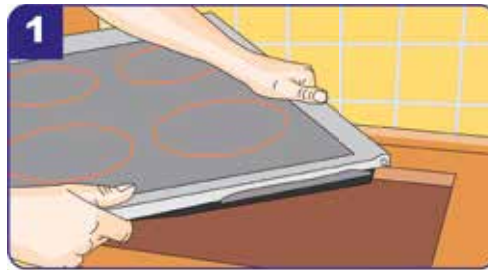
1 Vor Abbau der alten Arbeitsplatte die Sicherung des Kochfeldes ausschalten.
